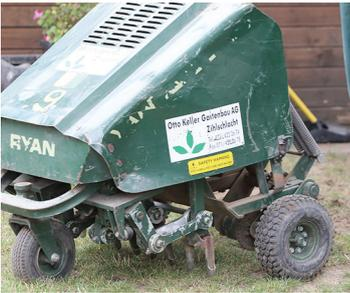
**DAS AERIFIZIEREN** ist vor allem bei verdichteten, eher schweren Böden unverzichtbar. Eine Spezialmaschine, die mit Hohlzinken ausgestattet ist, stantzt ca. 5cm lange Erdzapfen aus dem Boden und sorgt durch deren Entnahme für die Belüftung des Bodens. Wasser und Luft gelangen wieder in die unteren Schichten, das Wurzelwachstum der Gräser wird angeregt. Resultat ist in einigen Wochen ein vitaler, dichter Rasen. Die entstandenen Löcher füllt man mit Quarzsand oder einem speziellen Rasensubstrat.
